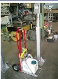
屋外可搬形 監視カメラポール
